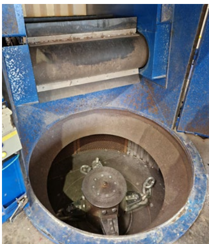
Blick in die Mahlkammer mit den Ketten, die die EBS durch Rotation zerkleinern
