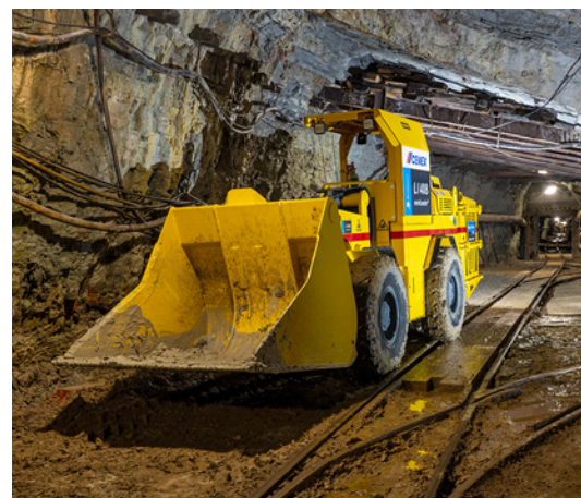
Batteriebetriebener elektrischer Fahrlader, seit 2024 im Einsatz unter Tage
